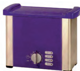
AP111 Appareil à ultrasons sans chauffage Système d'oscillations en sandwich à large diffusion Livré avec couvercle • Minuterie (0 à 15mn) • Dimension intérieure de la cuve : 190 x 85 x 60mm • Capacité : 0.85l • Fréquence : 33KHz • Puissance : 30W • 220 volts • Poids : 1.2Kg
