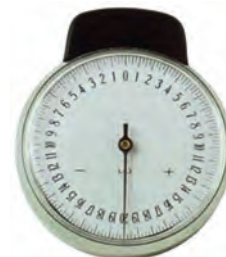
SP099 Sphéromètre avec pointes en métal Capacité: + ou - 20 dioptries La valeur en dioptries du verre est obtenue par l'addition des mesures lues sur les deux faces du verre.
