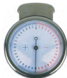
SP100 Sphéromètre avec pointes saphir Capacité: + ou - 20 dioptries La valeur en dioptries du verre est obtenue par l'addition des mesures lues sur les deux faces du verre.
